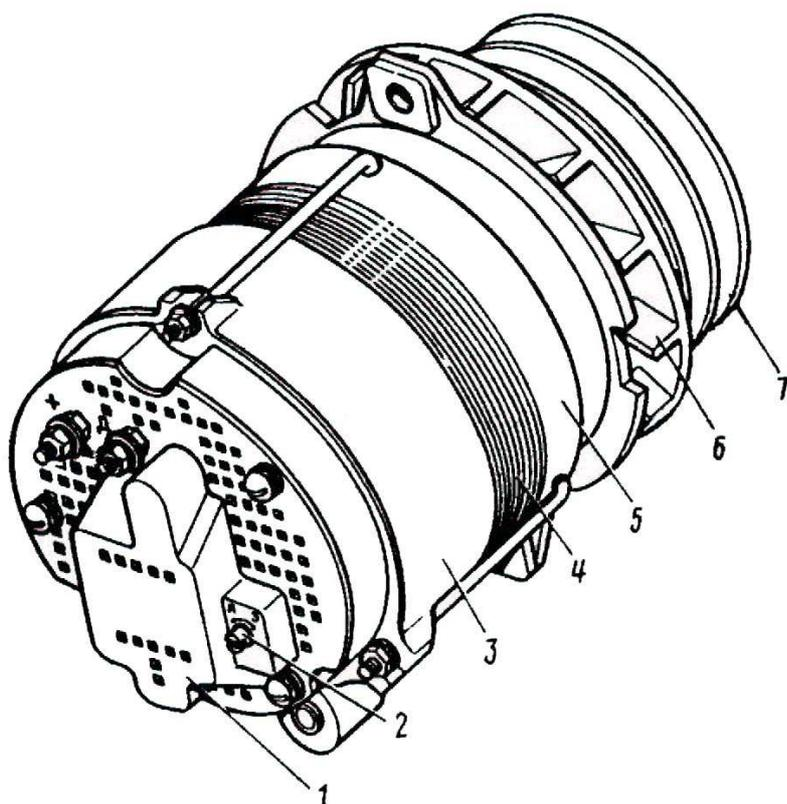
1 – крышка регулирующего устройства; 2\* – винт переключателя посезонной регулировки напряжения "Зима-Лето"; 3 – крышка задняя; 4 – статор; 5 – крышка передняя; 6 – вентилятор; 7 – шкив.
