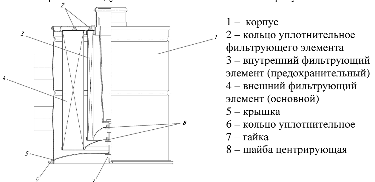
Рисунок ба - Воздухоочиститель с бумажным фильтрующим элементом (БФЭ).
